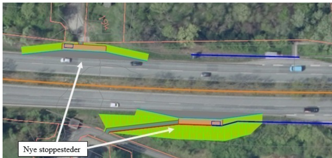
Figur 1: Otterupvej ved Slettensvej. Ny busstoppesteder 80 meter længere mod syd. Der etableres samtidig hegn i midterrabbatten (orange linje) og ved de eksisterende stoppesteder etableres der autoværn (blå linjer).
