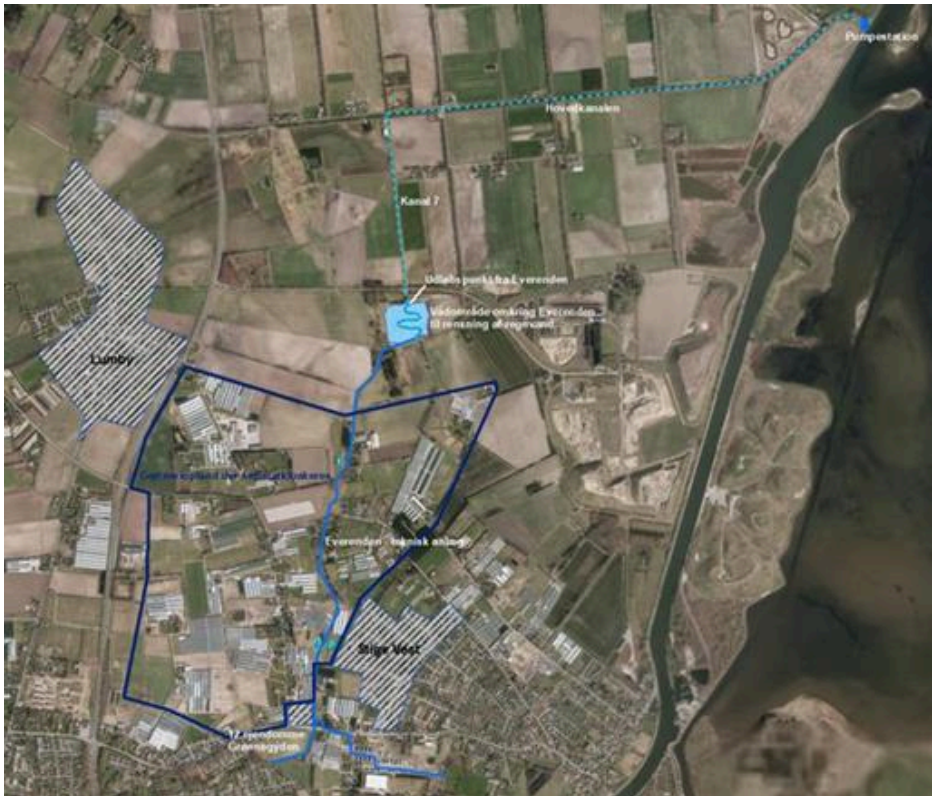
Figur 1: De kommende separatkloakerede områder ved Stige og Lumby er angivet med hvid skravering. Everenden er angivet med mellemlå streg fra syd for Haugevej og op til Strandløkkevej. Den lyseblå flade er det planlagte vådområde. Og den mørkeblå afgrænsning viser områder med gartnerier, som også ønskes separatkloakeret.
