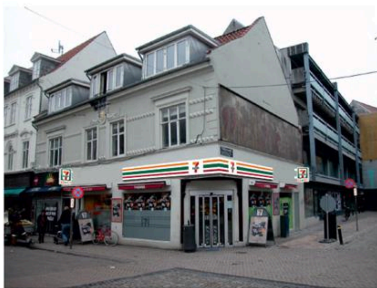
Facadeskilt 5250 + 4760 x 500 mm Skiltet fremstilles med hvid bagkasse – der bestykses med hvide LED lys. Fronterne udføres i hvid acryl, hvorpå logo monteres i folier.
